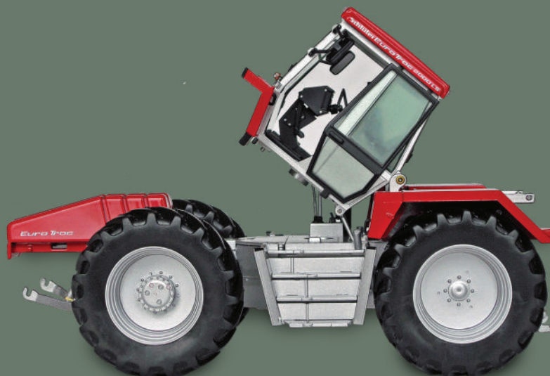
Seitenansicht mit vorgeschobenem Balast-Gewicht, geöffneter Schiebetür und gekippter Kabine.
