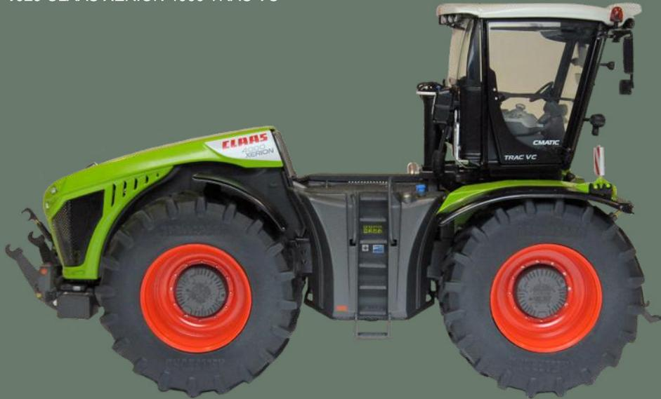
Seitenansicht mit um 180° nach hinten gedrehter Kabine.
